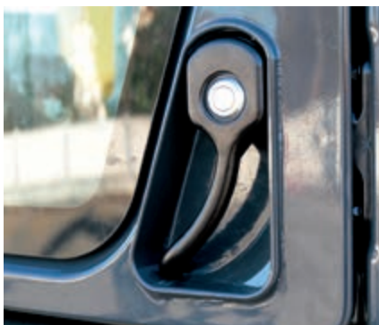
Facile l'accesso grazie alla maniglia installata nella parte inferiore della porta
